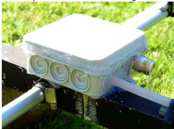
Schlauchklemmen an den Elementen befestigt und in einem Abstand von 5 mm zur Anschlußdose geführt. Als Abstandshalter dienten 5 mm dicke PVC Stücke die mit Isolierband und Schlingbandschellen gehalten werden. Als Koaxbuchse verwendete ich eine N-Norm-Buche, die mit Stücken des ehemaligen Abschirmgeflechtes des RG-213 eine gute Masseverbindung zum Boomrohr innerhalb der Anschlußdose bekam. Nach den Abstimmarbeiten und dem Einstellen des SWRs wurden alle Korrosion- und
