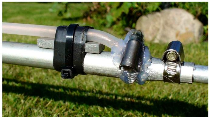
Als Phasenleitung benutzte ich die Seele eines RG-213-Koaxkabel ohne Geflecht und Mantel (man benötigt ca. 2 m). Als Anschlußdose benutzte ich eine Aufputz-Verteilerdose für 230V, die am Kreuzungspunkt mit dem kürzeren Element auf dem Boomrohr befestigt wurde. In der Anschlußdose
