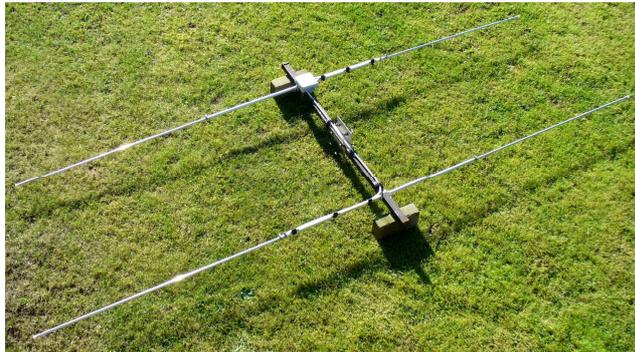
einige Rohre in meiner berühmten berüchtigten Bastelkiste hatte, habe ich die Maße der Rohre und des Booms etwas abgeändert. Das Boomrohr besteht bei mir aus 30 mm x 2 mm Vierkant Alu und die Elemente aus 10 mm x 1 mm bzw. 15 mm x 1 mm Alu rund. Das vordere Element ist 2770 mm lang und besteht aus 10 mm Rohr, das in der Mitte durch ein 1000 mm langes und 15 mm Rohr verstärkt wird.
